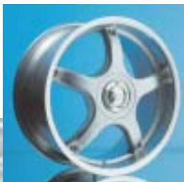
Abt Sportfelge A25 8,5 x 18 ET 35, einteilig gegossen
