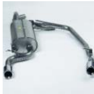
Abt Endschalldämpfer 2-Rohr, Ausgänge durch Originalausparung der Nebelschluß- und Rückfahrleuchte, Ø 70 mm, komplett Edelstahl inkl. Ersatz-Nebelschluß- und Rückfahrleuchte mit Rahmen.
