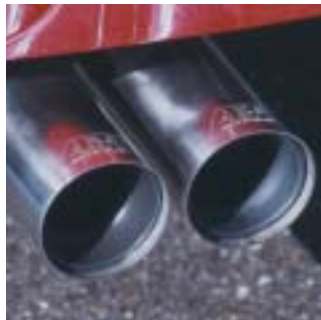
Abt Endschalldämpfer mit rundem Edelstahl-Doppelendrohr, Ø 76 mm.
