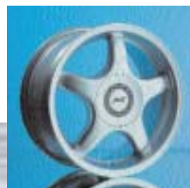
Abt Sportfelge A13 7 x 16 ET 35, einteilig gegossen
