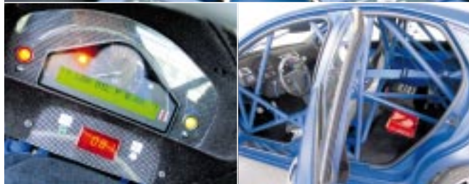
Mit Volvo hat das nicht mehr viel zu tun: Heico-eigenes Lenkrad mit belegbaren Knöpfen, Sitzschale mit Vierpunktgurt, Renninstrumente und Käfig. Die Tasten für Telefon und Klima sind Attrappen
