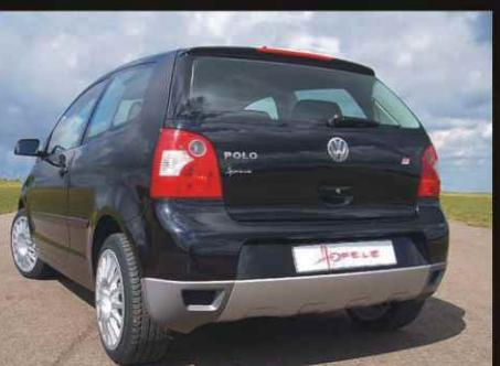
Rovnako je to aj v prípade zadného nárazníka. Taktiež je lakovaný troma farbami. Vrch je vo farbe karosérie, spodok v dvoch odtieňoch sivej. Oba nárazníky putujú už od výrobcu, teda od firmy Hofele Design, vybavené hliníkovými mriežkami.
